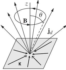
Usamos el circuito Amperiano  $C$  de la figura cuyo radio es  $r \sin \theta$ . Arriba del plano  $z = 0$  las líneas de campo magnético son círculos centrados en el eje  $z$  con dirección  $\mathbf{B}(z > 0) = B(r, \theta) \hat{\phi}$ . Abajo del plano  $z = 0$  también son círculos pero en dirección  $-\hat{\phi}$ . Para calcular  $I_d$  se usa una superficie delimitada por  $C$  que es un casquete de esfera, de modo que  $d\mathbf{a} = \hat{r} r^2 d\Omega$ . Así que la Ec. (1) da
